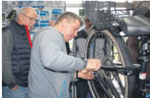
Schaltung verbogen: Markus Feist (rechts) erklärt Befestigung und Ausrichtung des Schaltwerkes; links daneben Teilnehmer Lothar Koch.
